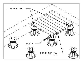
3. UTILIZANDO LOS POSTES DE LA TIRA, DESLIZE EL FS-12 EN EL CORTE CONTINUO KERF HACIA LOS PEDESTALES. LAS TIRAS EN LÍNEA CON EL PERÍMETRO DEBERAN SER CORTADAS CON UNA SIERRA COMO SE REQUIERAN PARA QUE SE PUEDAN CENTRAR CON CADA PEDESTAL.
