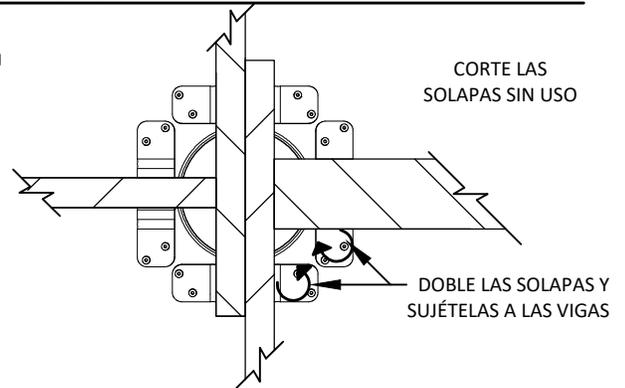
LOS ACCESORIOS PARA VIGAS PUEDEN USARSE CON VIGAS 2 X Y 4 X
