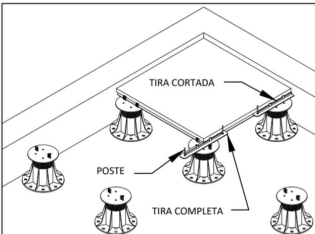
3. UTILIZANDO LOS POSTES DE LA TIRA, DESLIZE EL FS-12 EN EL CANAL. LAS TIRAS PERIMETRALES DEBERAN SER CORTADAS CON UNA SIERRA, SEGÚN SE REQUIERAN PARA QUE SE PUEDAN CENTRAR CON CADA PEDESTAL.
