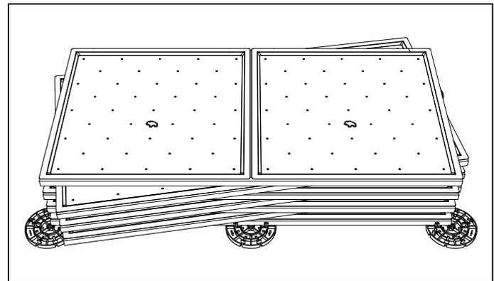
4. REPITA LOS 3 PRIMEROS PASOS, CUIDADOSAMENTE COLOQUE LAS BALDOSAS CON CHAROLAS UNA ENCIMA DE LA OTRA GIRANDOLAS COMO SE MUESTRA EN LA IMÁGEN. APILE NO MAS DE 10 BALDOSAS DÉJALAS SECAR DE 2 A 4 HRS O HASTA QUE EL ADHESIVO HAYA CURADO ANTES DE MANIPULARLAS
