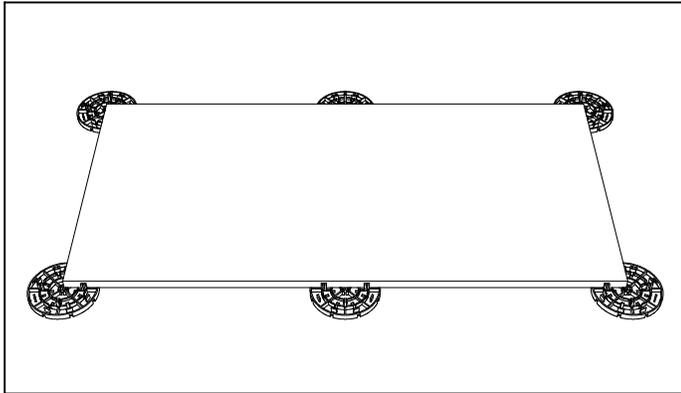
1. COLOQUE LA CARA TERMINADA DE LAS BALDOSAS BOCA ABAJO SOBRE LOS PEDESTALES COMO SE MUESTRA. TOME LAS BALDOSAS DE DIFERENTES CAJAS O PALLETS PARA LOGRAR UNA DISTRIBUCIÓN UNIFORME
