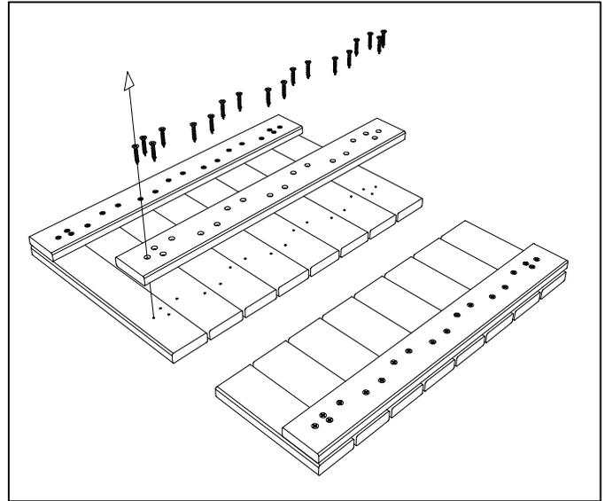
2. DESPUÉS DE CORTAR, VOLTEE LA BALDOSA Y REMUEVA LOS LISTONES INFERIORES DE LA PARTE QUE NO UTILIZARÁ, CON CUIDADO PARA NO DAÑAR LOS TORNILLOS.
