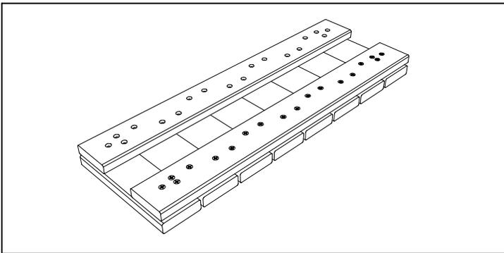
3. UTILIZANDO LOS LISTONES INFERIORES REMOVIDOS EN EL PASO 2, ALINEE LOS ORIFICIOS PARA PRE-TALADRAR EN LA PORCIÓN A INSTALAR. ASEGURE DE MANTENER UN ESPACIADO CONSISTENTE ENTRE LOS LISTONES SUPERIORES
