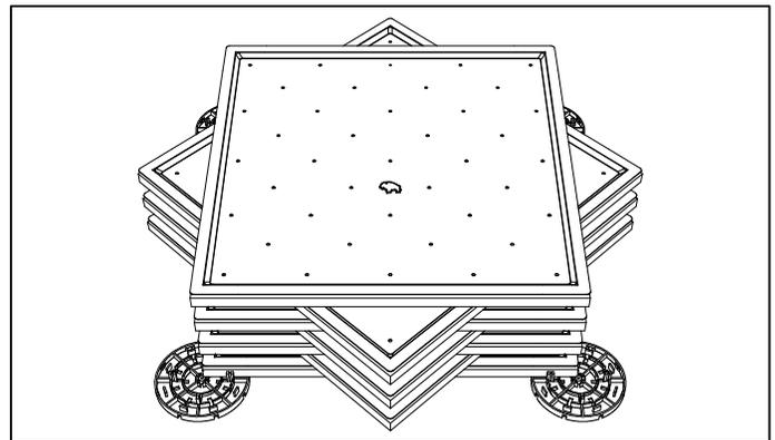
4. REPITA LOS 3 PRIMEROS PASOS, CUIDADOSAMENTE COLOQUE LAS BALDOSAS CON CHARORAS UNA ENCIMA DE LA OTRA GIRANDOLAS COMO SE MUESTRA EN LA IMÁGEN. APILE NO MAS DE 10 BALDOSAS DÉJALAS SECAR DE 2 A 4 HRS O HASTA QUE EL ADHESIVO HAYA CURADO ANTES DE MANIPULARLAS
