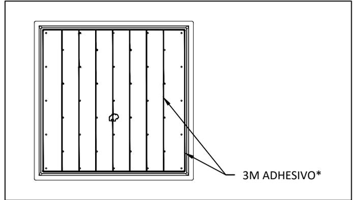
2. COLOQUE UNA LINEA DE 1/8" DEL ADHESIVO 3M. DISTRIBUYA 1/8" DESDE EL BORDE SUPERIOR DE LA CHAROLA Y 1/8" JUNTO A CADA LÍNEA DE AGUJEROS COMO SE MUESTRA EN LA IMÁGEN. IMPORTANTE: PARA UNA ADHESIÓN CORRECTA, EL ADHESIVO SE DEBE DE COLOCAR EXACTAMENTE COMO SE MUESTRA EN LA IMÁGEN. PARA PREVENIR QUE ENTRE LA HUMEDAD ENTRE LA CHAROLA Y LA BALDOSA COLOQUE UN PERÍMETRO CONTINUO DE ADHESIVO EN EL BORDE DE LA CHAROLA.
