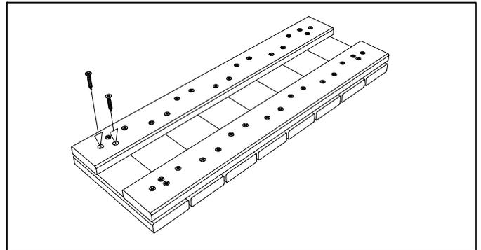
4. DEPUÉS DE PRE-TALADRAR, ATORNILLE LOS LISTONES INFERIORES EN LA PORCIÓN A INSTALAR, RE UTILICE LOS TORNILLOS REMOVIDOS EN EL PASO 2
