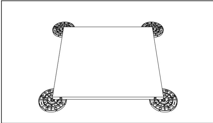
1. COLOQUE LA CARA TERMINADA DE LAS BALDOSAS BOCA ABAJO SOBRE LOS 4 PEDESTALES COMO SE MUESTRA. TOQUE LAS BALDOSAS DE DIFERENTES CAJAS O PALLETS PARA LOGRAR UNA DISTRIBUCIÓN UNIFORME
