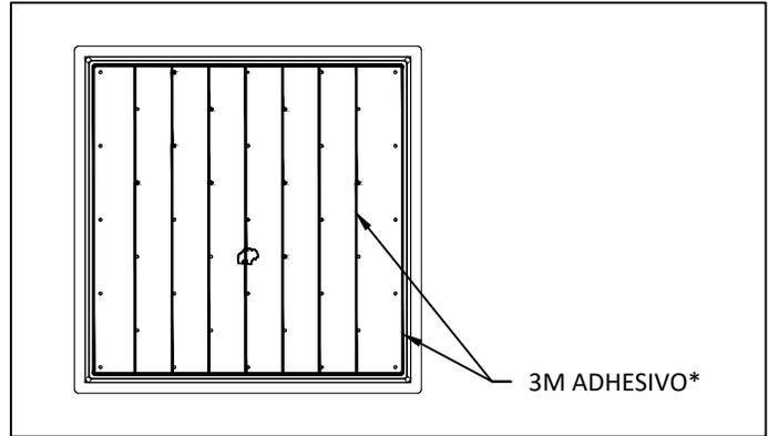
2. COLOQUE UNA LINEA DE 1/8" DEL ADHESIVO 3M. DISTRIBUYA 1/4" DESDE EL BORDE SUPERIOR DE LA CHAROLA Y 1/8" JUNTO A CADA LÍNEA DE AGUJEROS COMO SE MUESTRA EN LA IMÁGEN. IMPORTANTE: PARA UNA ADHESIÓN CORRECTA, EL ADHESIVO SE DEBE DE COLOCAR EXACTAMENTE COMO SE MUESTRA EN LA IMÁGEN. PARA PREVENIR QUE ENTRE LA HUMEDAD ENTRE LA CHAROLA Y LA BALDOSA COLOQUE UN PERÍMETRO CONTINUO DE ADHESIVO EN EL BORDE DE LA CHAROLA.
