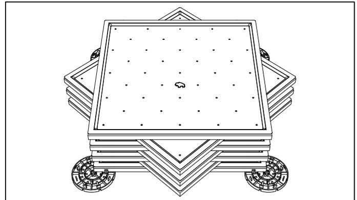
4. REPITA LOS 3 PRIMEROS PASOS, CUIDADOSAMENTE COLOQUE LAS BALDOSAS CON CHAROLAS UNA ENCIMA DE LA OTRA GIRANDOLAS COMO SE MUESTRA EN LA IMÁGEN. APILE NO MAS DE 10 BALDOSAS DÉJALAS SECAR DE 2 A 4 HRS O HASTA QUE EL ADHESIVO HAYA CURADO ANTES DE MANIPULARLAS
