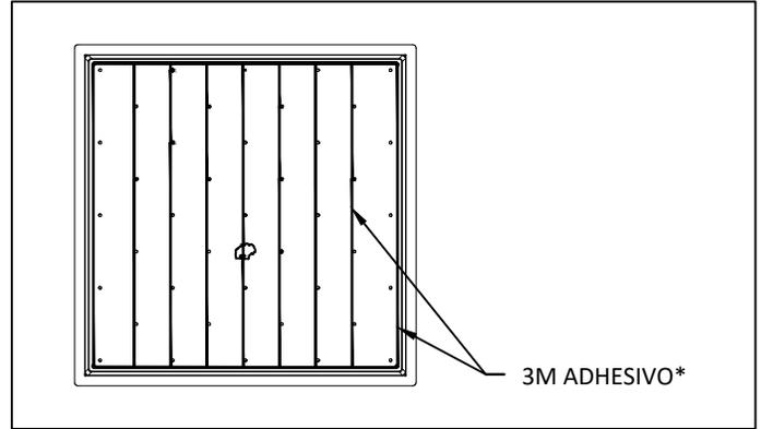
2. COLOQUE UNA LÍNEA DE 1/8" DEL ADHESIVO 3M. DISTRIBUYA 1/4" DESDE EL BORDE SUPERIOR DE LA CHAROLA Y 1/8" JUNTO A CADA LÍNEA DE AGUJEROS COMO SE MUESTRA EN LA IMÁGEN. IMPORTANTE: PARA UNA ADHESIÓN CORRECTA, EL ADHESIVO SE DEBE DE COLOCAR EXACTAMENTE COMO SE MUESTRA EN LA IMÁGEN. PARA PREVENIR QUE ENTRE LA HUMEDAD ENTRE LA CHAROLA Y LA BALDOSA COLOQUE UN PERÍMETRO CONTINUO DE ADHESIVO EN EL BORDE DE LA CHAROLA
