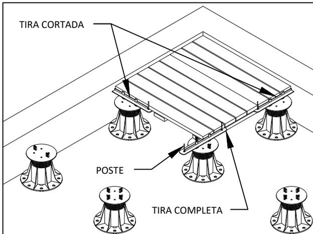
3. UTILIZANDO LOS POSTES DE LA TIRA, DESLIZE EL FS-12 EN EL CORTE CONTINUO KERF HACIA LOS PEDESTALES. LAS TIRAS EN LÍNEA CON EL PERÍMETRO DEBERAN SER CORTADAS CON UNA SIERRA COMO SE REQUIERAN PARA QUE SE PUEDAN CENTRAR CON CADA PEDESTAL.
