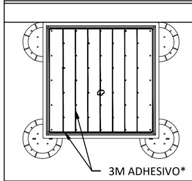
2. COLOQUE UNA LÍNEA DE 1/8" DEL ADHESIVO 3M. DISTRIBUYA 1/4" DESDE EL BORDE SUPERIOR DE LA CHAROLA Y 1/8" JUNTO A CADA LÍNEA DE AGUJEROS COMO SE MUESTRA EN LA IMÁGEN. IMPORTANTE: PARA UNA ADHESIÓN CORRECTA EL ADHESIVO SE DEBE DE COLOCARSE EXACTAMENTE COMO SE MUESTRA EN LA IMÁGEN; PARA PREVENIR QUE ENTRE LA HUMEDAD ENTRE LA CHAROLA Y LA BALDOSA COLOQUE UN PERÍMETRO CONTINUO DE ADHESIVO EN EL BORDE DE LA CHAROLA
