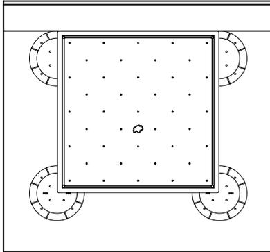
1. COLOQUE LA CHAROLA EN CUATRO (4X) PEDESTALES Y REMUEVA LAS LENGÜETAS COMO SE REQUIERAN PARA COLOCARSE EN EL PERÍMETRO O CON LOS SUJETADORES FS-12
