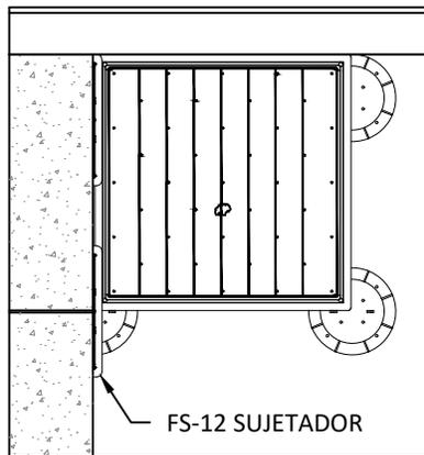
5. SIGUIENDO EL MÉTODO "T" DE INSTALACIÓN COMIENCE DESDE EL MURO PERIMETRAL O DE LA LONGITUD DE LA PARED, COLOQUE LOS SUJETADORES FS-12 EN EL CANAL QUE SE FORMA ENTRE LAS CHAROLAS Y LAS BALDOSAS Y CONTINÚA CON LA INSTALACIÓN. ESTO TE AYUDARÁ A MANTENER EL ESPACIO Y AL ATORNILLARLO A LOS PEDESTALES ASEGURARÁ EL SIETEMA. CUANDO TODAS LAS BALDOSAS ESTÉN INSTALADAS Y EL ADHESIVO CURADO, CUIDADOSAMENTE REMUEVA LOS POSTES DE LA TIRA CON PINZAS. \*NO USE MARTILLO PARA QUITAR LOS POSTES
