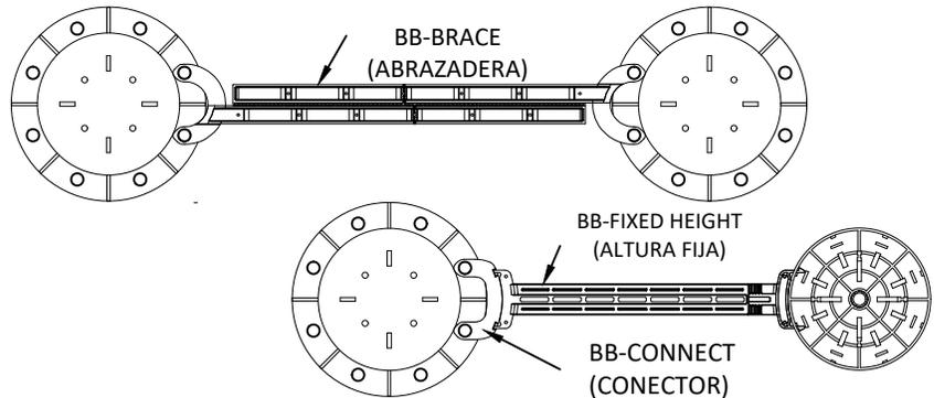
4. CIERRE LOS BRAZOS DE LA ABRAZADERA INSERTANDO UN SEGURO BB- LATCH A CADA LADO, GIRÁNDOLOS A 90° O INSERTE LOS TORNILLO BB-SCREW EN LA PARTE SUPERIOR DE LOS PEDESTALES DE ALTURA FIJA
