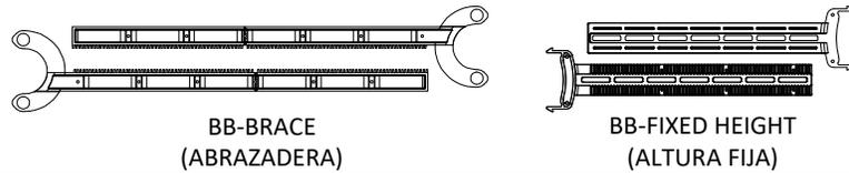
3. FIJE LA ABRAZADERA EN LAS PIJAS DE CADA PEDESTAL AJUSTABLE. PARA PEDESTALES DE ALTURA FIJA. COLOQUE LA ABRAZADERA A UN LADO DE UN HD50 O HD75. UTILICE UN CONECTOR PARA SUJETAR UN PEDESTAL AJUSTABLE CON UNO DE ALTURA FIJA
