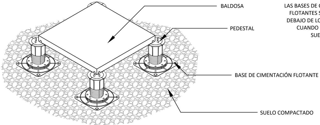
LAS BASES DE CIMENTACIÓN FLOTANTES SE REQUIEREN DEBAJO DE LOS PEDESTALES CUANDO SE INSTALA EN SUELO INESTABLE
