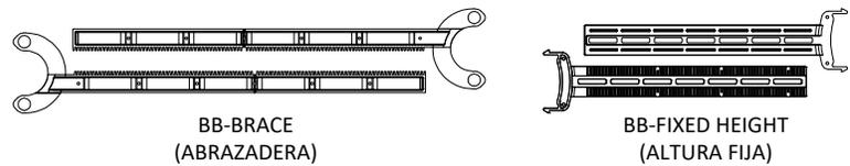
3. FIJE LA ABRAZADERA EN LAS PIJAS DE CADA PEDESTAL AJUSTABLE. PARA PEDESTALES DE ALTURA FIJA, COLOQUE LA ABRAZADERA A UN LADO DE UN HD50 O HAD75. UTILICE UN CONECTOR PARA SUJETAR UN PEDESTAL AJUSTABLE CON UNO DE ALTURA FIJA
