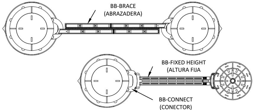
4. CIERRE LOS BRAZOS DE LA ABRAZADERA INSERTANDO UN SEGURO BB- LATCH A CADA LADO, GIRÁNDOLOS A 90° O ISERTE LOS TORNILLO BB-SCREW EN LA PARTE SUPERIOR DE LOS PEDESTALES DE ALTURA FIJA
