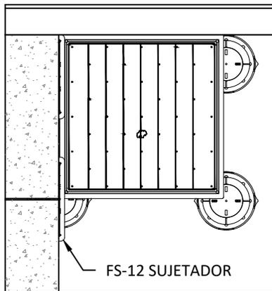
5. SIGUIENDO EL MÉTODO "T" DE INSTALACIÓN COMIENZE DESDE EL MURO PERIMETRAL O DE LA LONGITUD DE LA PARED, COLOQUE LOS SUJETADORES FS-12 EN EL CANAL QUE SE FORMA ENTRE LAS CHAROLAS Y LAS BALDOSAS Y CONTINÚA CON LA INSTALACIÓN. ESTO TE AYUDARÁ A MANTENER EL ESPACIADO Y AL ATORNILLARLO A LOS PEDESTALES ASEGURARÁ EL SIETEMA. CUANDO TODAS LAS BALDOSAS ESTÉN INSTALADAS Y EL ADHESIVO CURADO, CUIDADOSAMENTE REMUEVA LOS POSTES DE LA TIRA CON PINZAS. \*NO USE MARTILLO PARA QUITAR LOS POSTES
