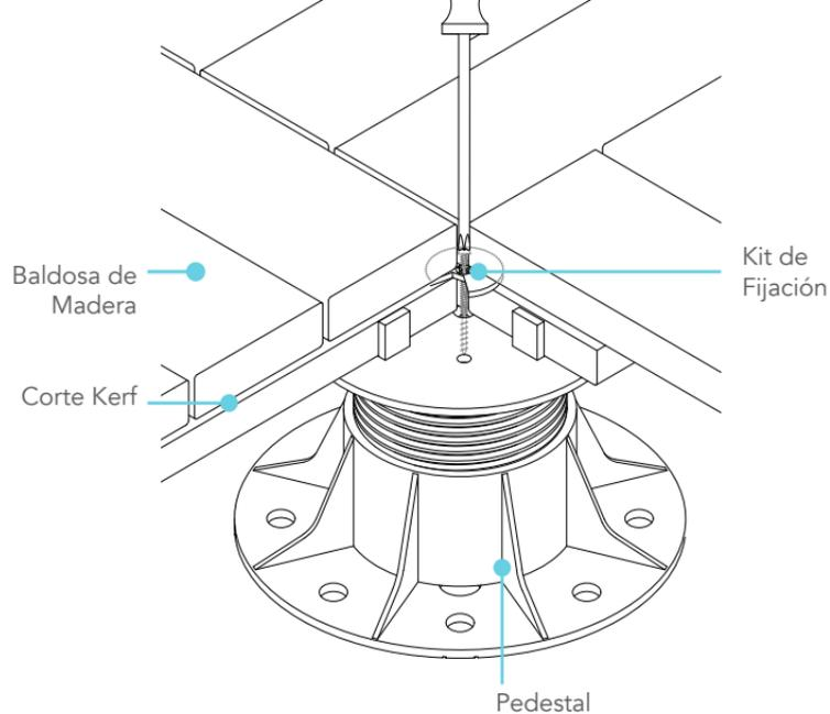
**Bison recomienda el uso de los pedestales con el kit de fijación o las tiras (splines) cuando se instalen baldosas de madera y/o porcelánicas.**
