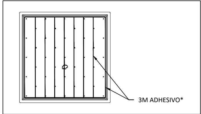
2. COLOQUE UNA LINEA DE 1/8" DEL ADHESIVO 3M. DISTRIBUYA 1/4" DESDE EL BORDE SUPERIOR DE LA CHAROLA Y 1/8" JUNTO A CADA LÍNEA DE AGUJEROS COMO SE MUESTRA EN LA IMAGEN. IMPORTANTE: PARA UNA ADHESIÓN CORRECTA, EL ADHESIVO SE DEBE DE COLOCAR EXACTAMENTE COMO SE MUESTRA EN LA IMAGEN. PARA PREVENIR QUE ENTRE LA HUMEDAD ENTRE LA CHAROLA Y LA BALDOSA COLOQUE UN PERÍMETRO CONTINUO DE ADHESIVO EN EL BORDE DE LA CHAROLA
