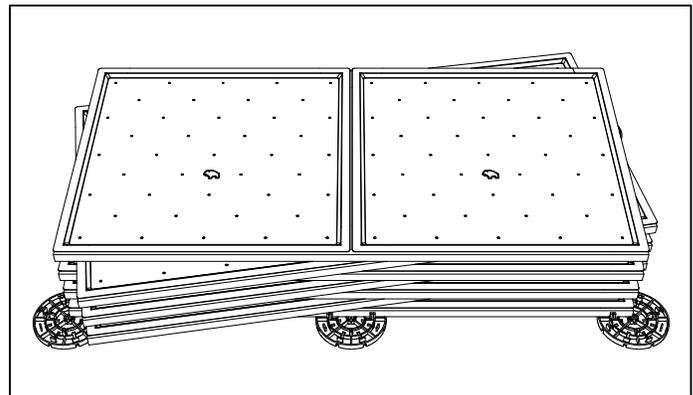
4. REPITA LOS 3 PRIMEROS PASOS, CUIDADOSAMENTE COLOQUE LAS BALDOSAS CON CHAROLAS UNA ENCIMA DE LA OTRA GIRANDOLAS COMO SE MUESTRA EN LA IMAGEN. APILE NO MAS DE 10 BALDOSAS DÉJALAS SECAR DE 2 A 4 HRS O HASTA QUE EL ADHESIVO HAYA CURADO ANTES DE MANIPULARLAS
