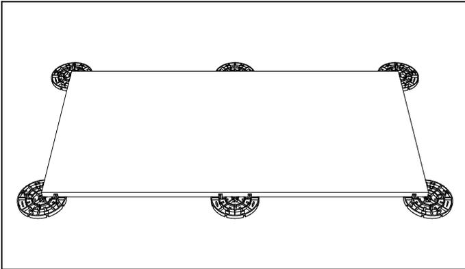
1. COLOQUE LA CARA TERMINADA DE LAS BALDOSAS BOCA ABAJO SOBRE LOS PEDESTALES COMO SE MUESTRA. TOMA LAS BALDOSAS DE DIFERENTES CAJAS O PALLETS PARA LOGRAR UNA DISTRIBUCIÓN UNIFORME
